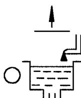
Заливка жидкости в емкость
