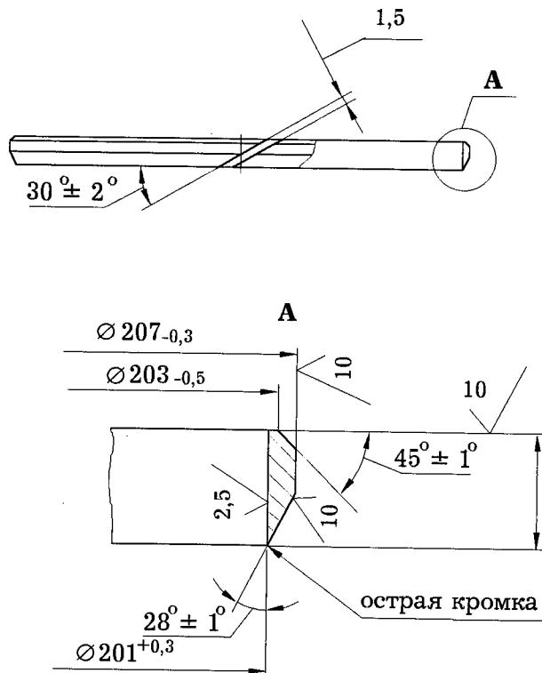
Схема установки демонтажного кольца
