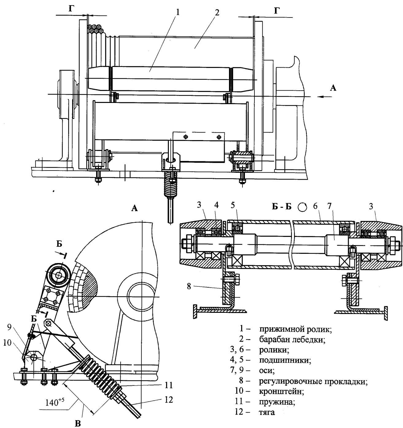
Рисунок 24 – Прижимной ролик
