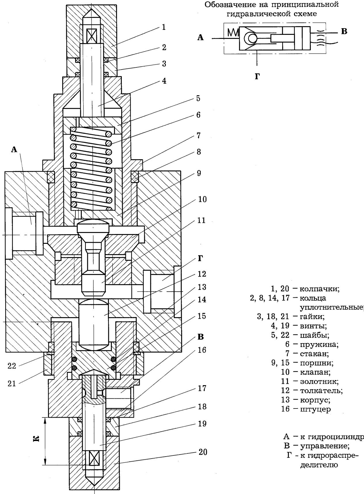
**Рисунок 49 - Клапан обратный управляемый**
