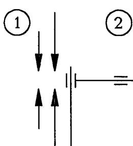
Выдвижение – втягивание первой и второй выносных опор и направление движения рычагов управления
