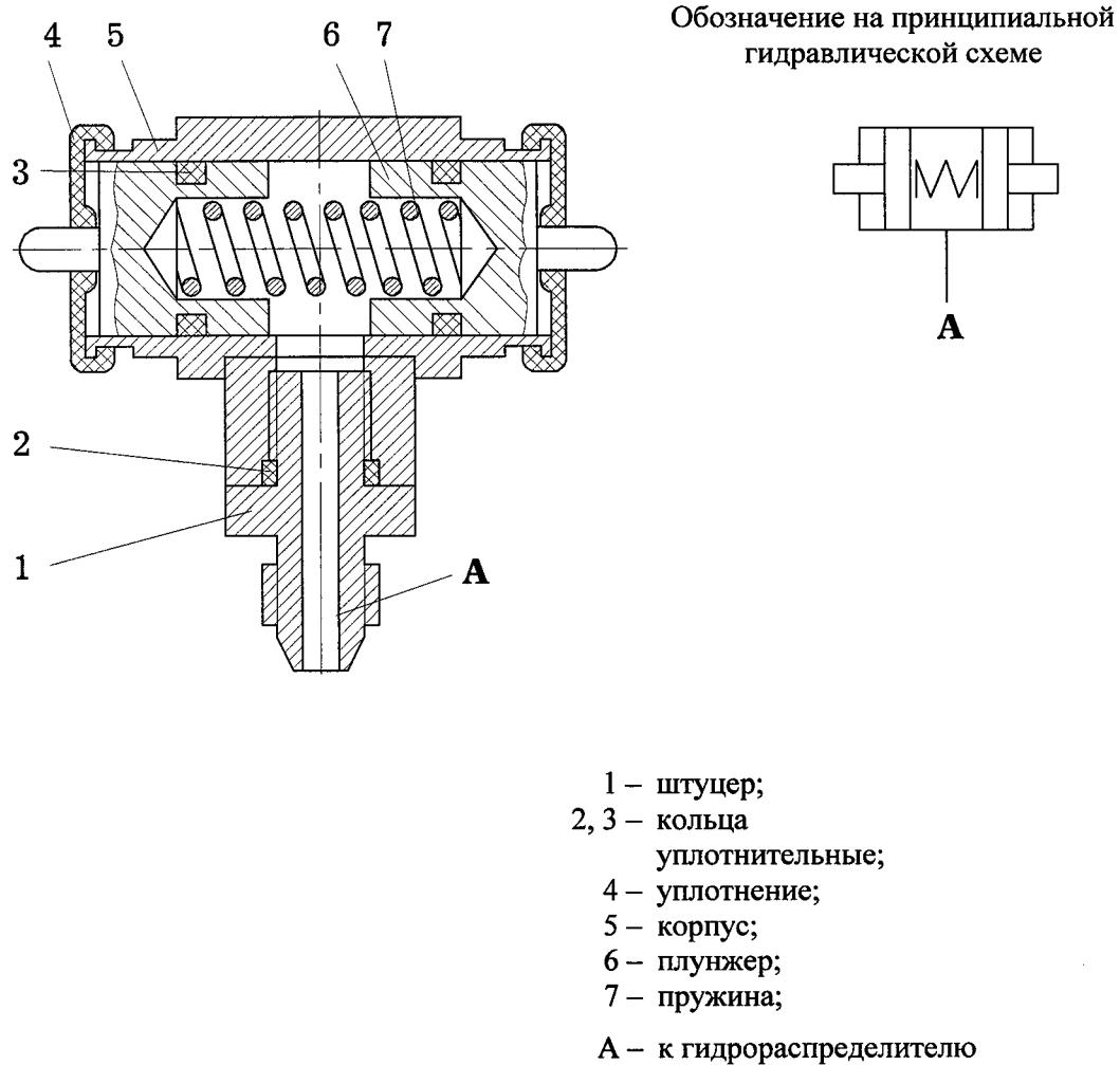
Рисунок 48 – Размыкатель тормоза механизма поворота
