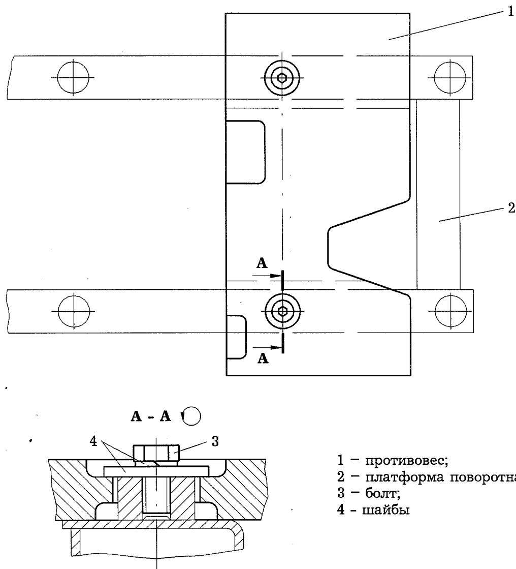
**Рисунок 17 - Установка противовеса**
