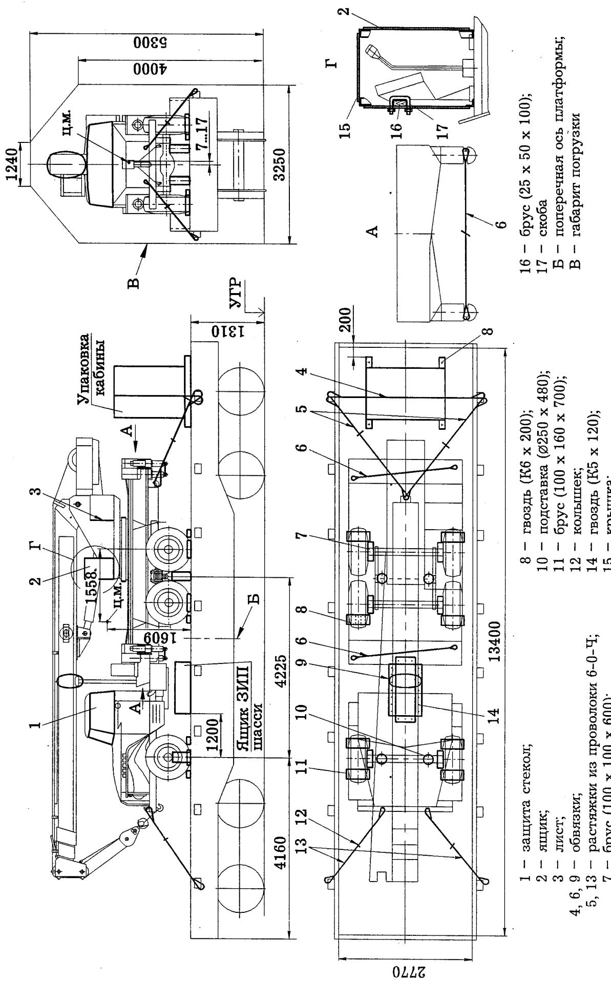
**Рисунок 67 - Размещение и крепление крана на четырехосной ж.-д. платформе с использованием деревянных упорных брусков и проволочных растяжек (габарит 1-Т)**
