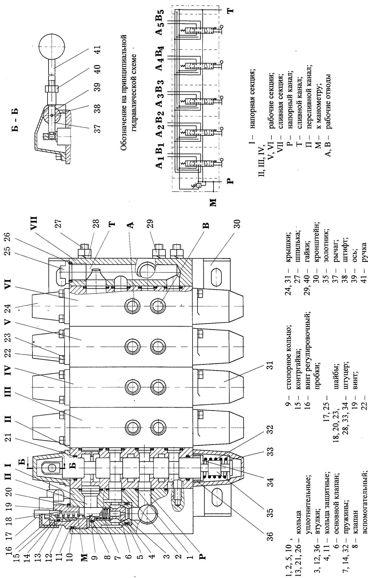
**Рисунок 39 - Гидрораспределитель**
