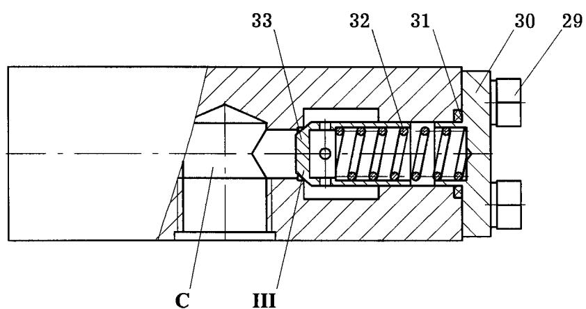
Рисунок 51.2 – Гидроблок уравновешивания
