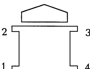
Схема расположения выносных опор на кране
