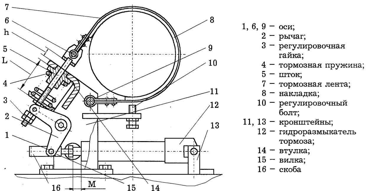
**Рисунок 22 - Тормоз ленточный**
