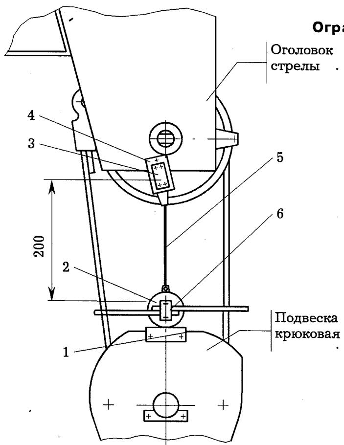
**Ограничитель глубины опускания**
