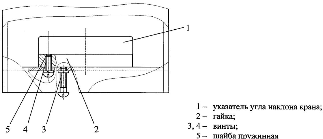
**Рисунок 60 – Установка указателя угла наклона крана**
