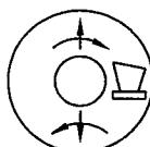
Поворот платформы и включение звукового сигнала
