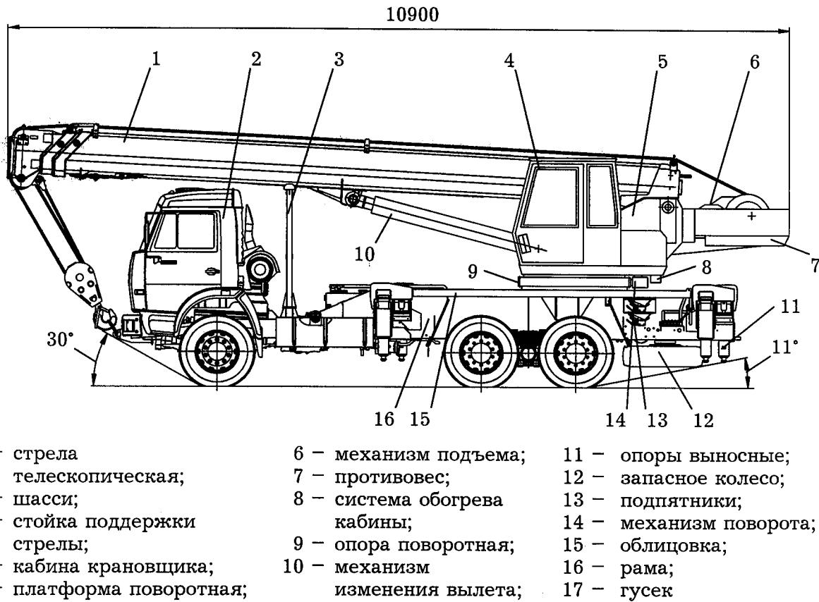
**Рисунок 1 - Общий вид крана в транспортном положении (вид сбоку)**
