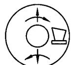
Поворот платформы и включение звукового сигнала
